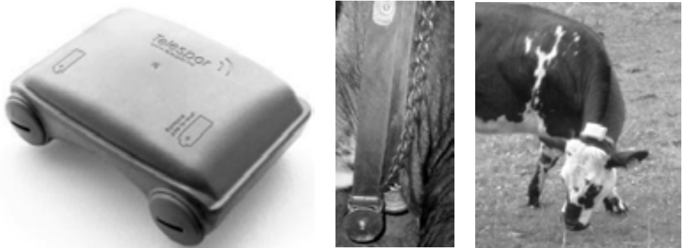
Abb. 1: GPRS-Terminal (10,7 x 7,6 x 3,7 cm) befestigt am Halsriemen mit Gegengewicht Fig. 1: GPRS-Terminal (10.7 x 7.6 x 3.7 cm) attached to collar with counter weight
