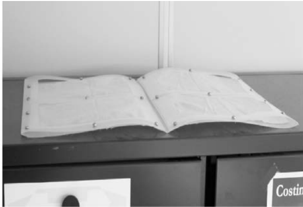
Abb. 1: Der EDC-Sampler besteht aus vier elektrostatischen Tüchern, die in einer Plastik-Faltmappe (40 x 30 cm) befestigt sind. Die Staubsammlung erfolgt in der horizontalen Position über einen Zeitraum von 14 Tagen
